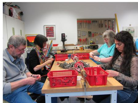
*Für eine Metallveredelungsfirma werden Teile abgeklebt, die später verzinkt werden.*
